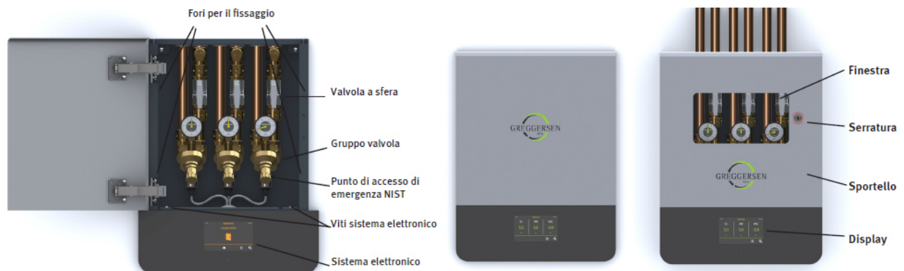
Componenti del quadro di intercettazione di area Ventus evo
